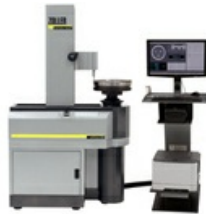
Das ZOLLER »millCheck« Einstellen und Messen von Planmesserköpfen und Cap-Fräsern
