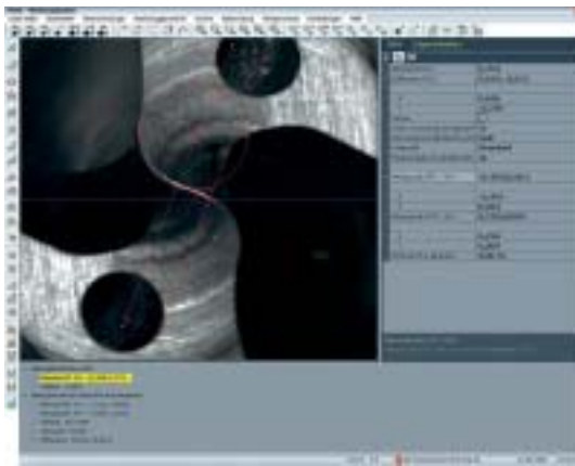
Medición bajo luz incidente en sentido axial con »metis« para cualquier parámetro en la geometría frontal
