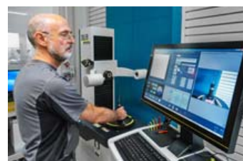
Dank der grafischen Lageroberfläche des ZOLLER-Toolmanagements holt sich ein Mitarbeiter der SIM das gewünschte Werkzeug zielsicher aus dem Werkzeuglager des Hänel-Lifts.
