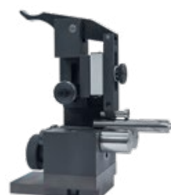
Porte-outils »pomRoll«-RP lite* pour »pomBasic« et »pomBasicMicro«, diamètre de tige à serrage direct : 3 – 19 mm, concentricité 0,004 mm
