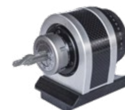
Unité de rotation »pomRoto«*, Diamètre de queue serrable grâce aux pinces de serrage : 1,5 – 16 mm, Longueur d'outil max. : 400 mm, concentricité : 0,006 mm
