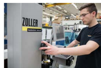
Dispositif de réglage et de mesure à commande numérique de ZOLLER »venturion 450«
