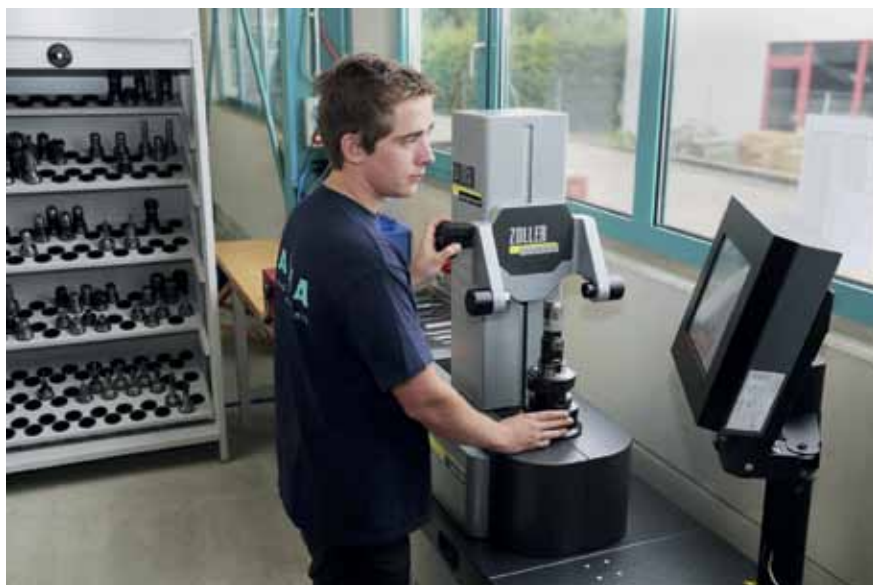
Bild 1: Professionelle Werkzeugeinstellung inklusive steuerungsgerechter Datenübertragung an die Maschine
