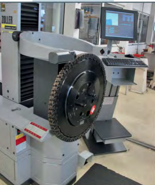
2 Bei Zoller Gemini ist die Werkzeugaufnahmespindel vertikal angebracht und mit CNC-Antrieb ausgestattet. Die ergonomische Anordnung erleichtert die Montage der Schneiden
