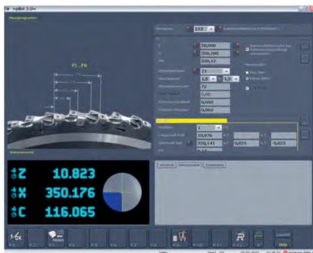
3 Gemini misst vollautomatisch Größtmaß in Z und X, Schneidenwinkel, Schneidenradius, Schneidhöhlenschlag und Rundlauf. Die Zoller Software Pilot 3.0 dokumentiert alles und archiviert für Wiederholaufräge
