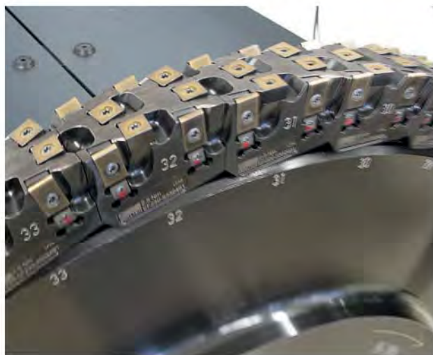
4 Werden die einzelnen Kassetten auf einem Fräser nach und nach ausgetauscht, können sich minimale Teilungsfehler ergeben. Im Gegensatz zum alten Einstellgerät stört sich Gemini daran nicht
