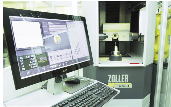
Ready – robo – go: vollautomatische Komplettvermessung, Beschriftung und Protokollierung in einem Vorgang.
