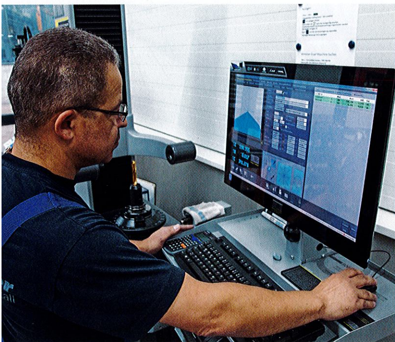
Alles einheitlich: Die Bedienoberfläche der Geräte sowie des Toolmanagements ist identisch – so finden sich die Mitarbeiter schnell zurecht. Bild: Zoller
