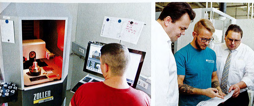
Zoller-Universalmessmaschine genius ProProTec zur Komplettkontrolle der Werkzeuge.
