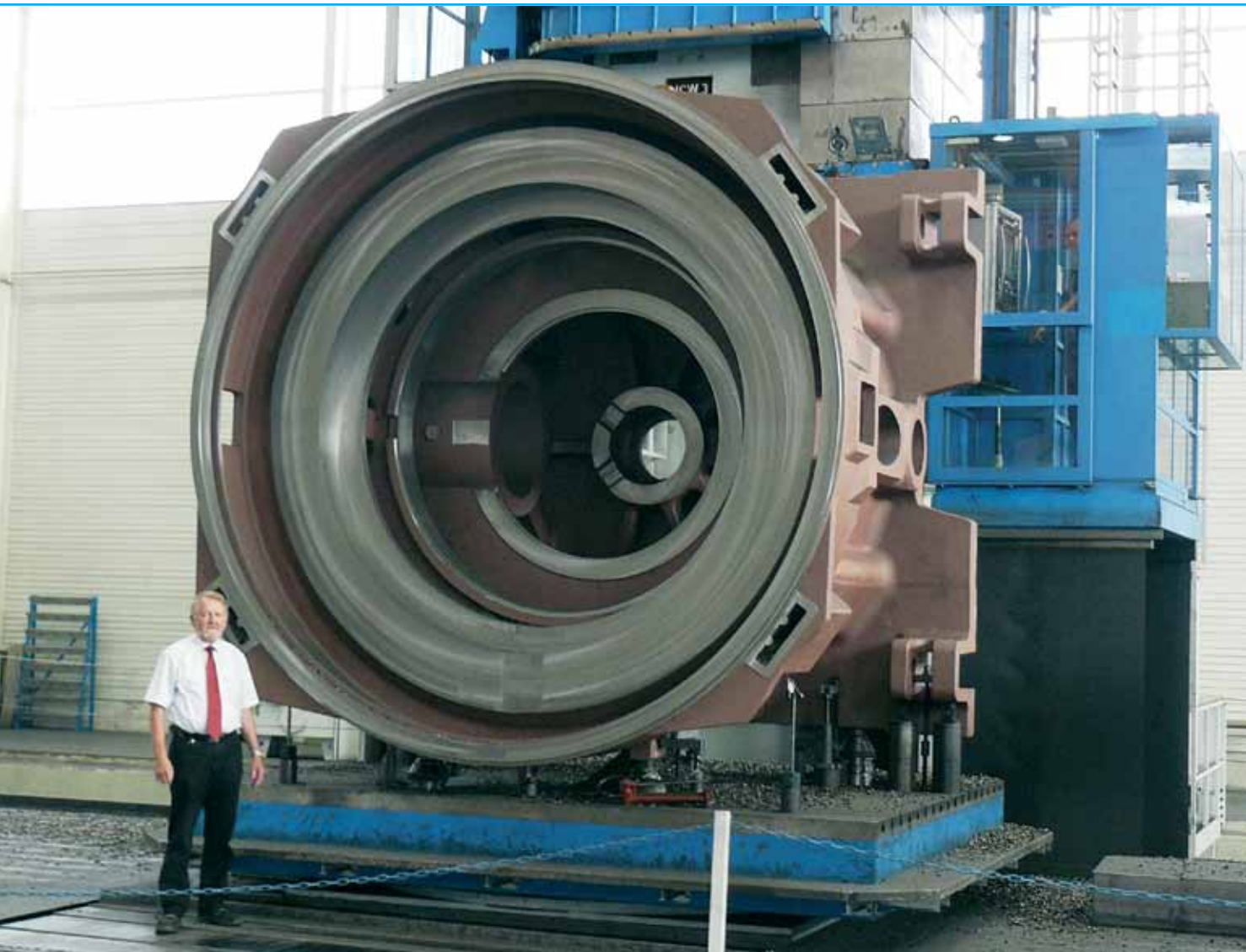
Bild 3: Es können Getriebegehäuse bis zu 80 Tonnen gefertigt werden – und zwar im Toleranzbereich IT6 und IT7
