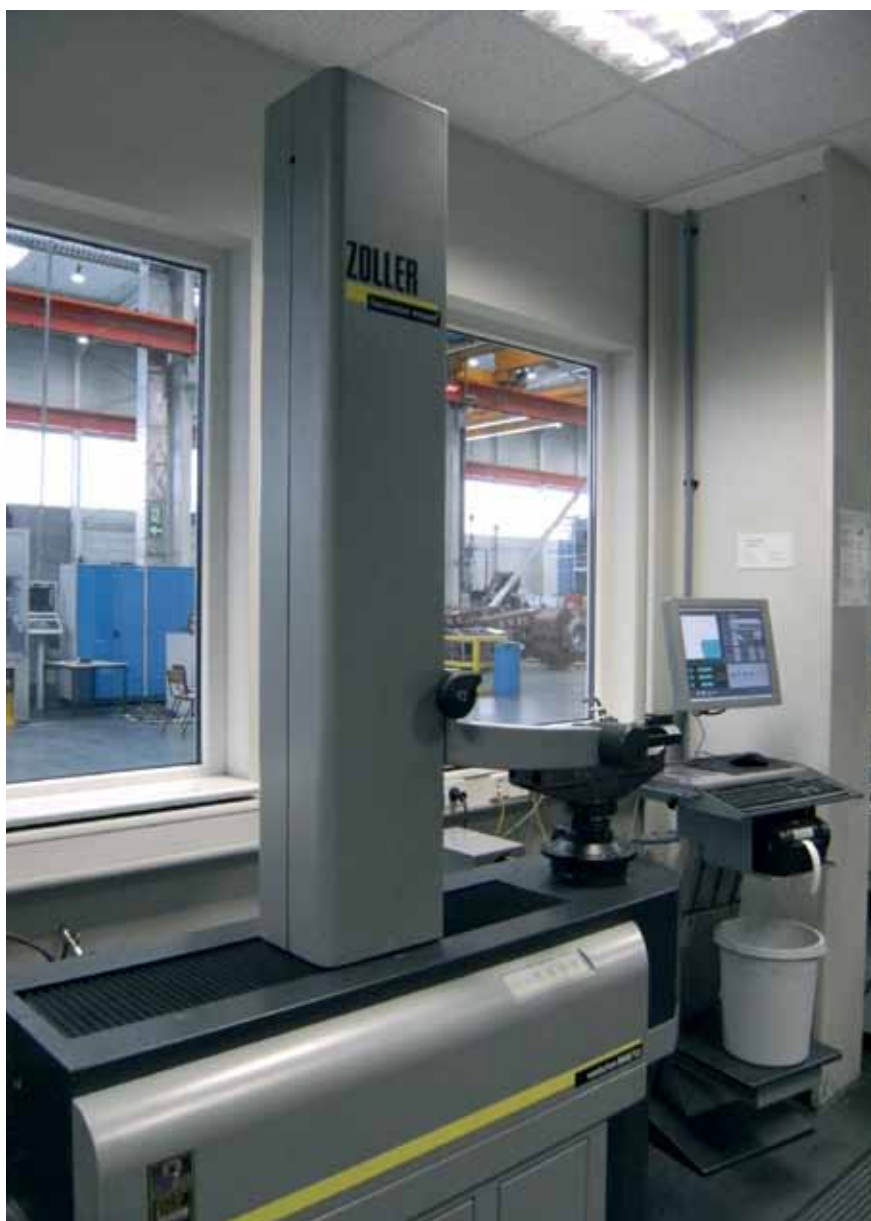
Bild 1: Das venturion 800 ausgestattet mit Zoller Bildverarbeitungssoftware pilot 3.0
