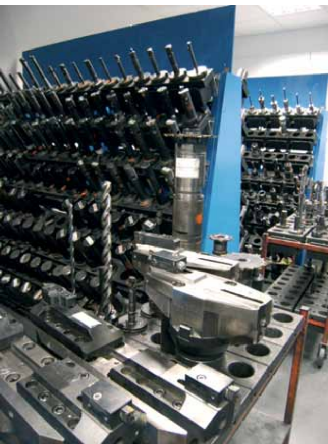
Bild 2: Während die Spindelwerkzeuge nur eine Länge von maximal 300 mm haben, sind Bohrer, Fräser etc. bis zu 800 mm lang
