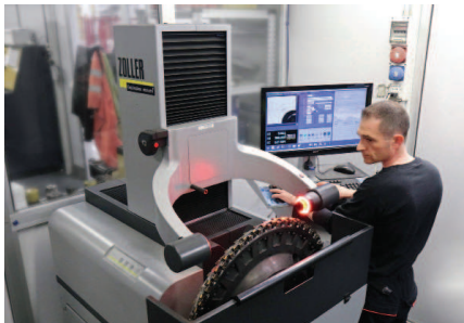
gemi: schnelle und sichere Ver- messung der Kurbelwellen- fräser.
