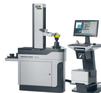
ZOLLER-Einstell- und Messgerät »venturion« zum hauptzeitparallelen Messen und Einstellen von Werkzeugen für längere Spindellaufzeiten
