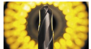
Ganzheitliches Vermessen von Werkzeugen im Durch- und Auflicht
