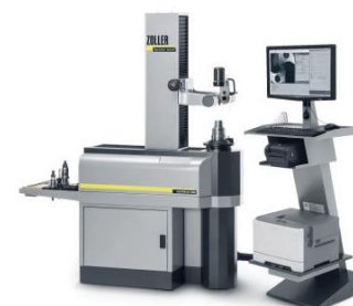
Einfaches und berührungsloses Messen und Prüfen von Werkzeugen aller Art mit »smartCheck«
