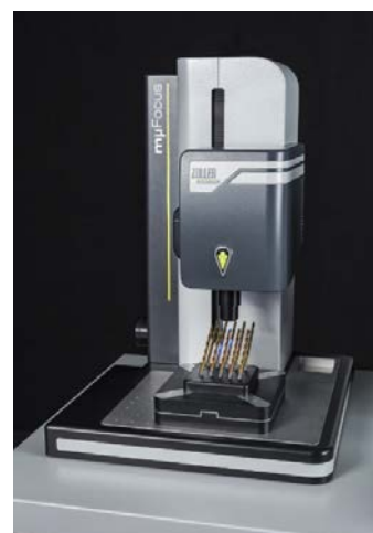
»mµFocus« zur einfach Rauheitsmessung und Vermessung der Schneidkantenpräparation
