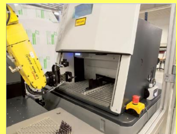
Laserbeschriftung: Schnelle und präzise Positionierung der Werkzeuge auf das Ablageprisma
