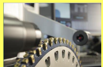
Einstell- und Messgerät »gemini 2«: Einfaches und schnelles Einstellen von Kurbelwellenfräsern und Dreh-/Räumwerkzeugen.
