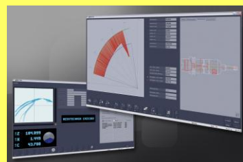
Das Messprogramm MP 28 für automatische Ermittlung der Voll- und Eckradien sowie grafische Auswertung des Konturverlaufs der Schneide.
