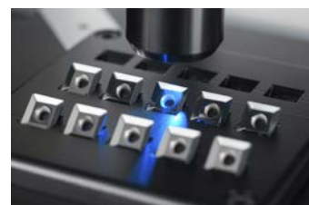
»mµFocus« misst die Schneidkantenpräparation und die Rauheit von Werkzeugen und Schneidplatten
