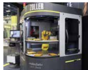
Qualitätskontrolle voll automatisiert: Der 24/7 Check »roboSet«
