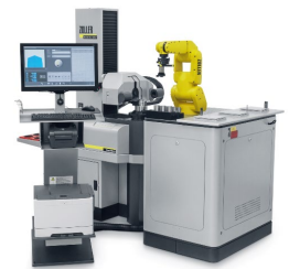
Abb. 7: Automationslösung zur Vermessung von Gewindewerkzeugen. Reinigungs- und Beschriftungsanlagen ergänzen die Inspektion.
