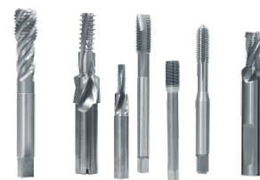
Abb. 2: Diverse steigungsbehaftete Werkzeuge
