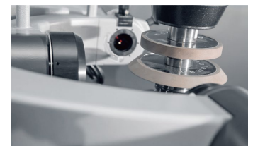
Abb. 8: Vermessung von Schleifscheiben für optimale Schleifergebnisse
