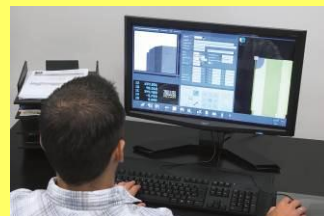
Interaktives Messen des Werkzeuges sowohl im Durchlicht als auch im Auflicht.
