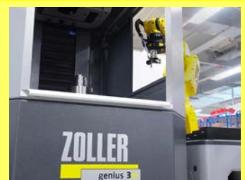
Automatischer Werkzeug-Check: ZOLLER »roboSet« mit Universal- messmaschine »genius«
