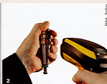
2 Scannen der eindeutigen Werkzeugidentifikation.
