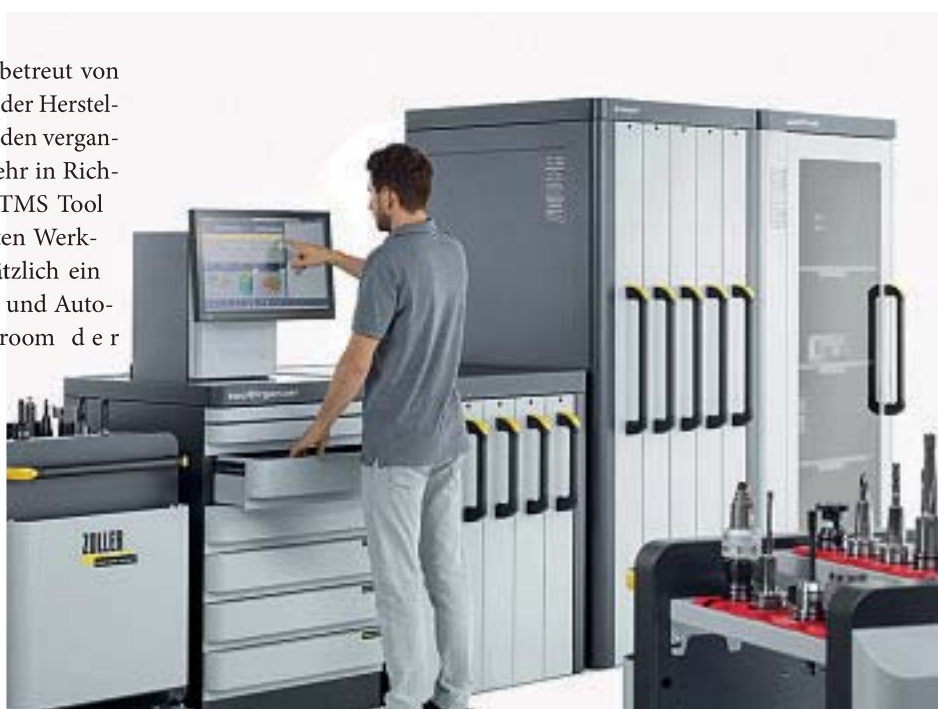
Die Smart Cabinets bieten eine schnelle Übersicht zu den im Toolroom eingelagerten Werkzeugen und Komponenten. (Bild: Zoller)
