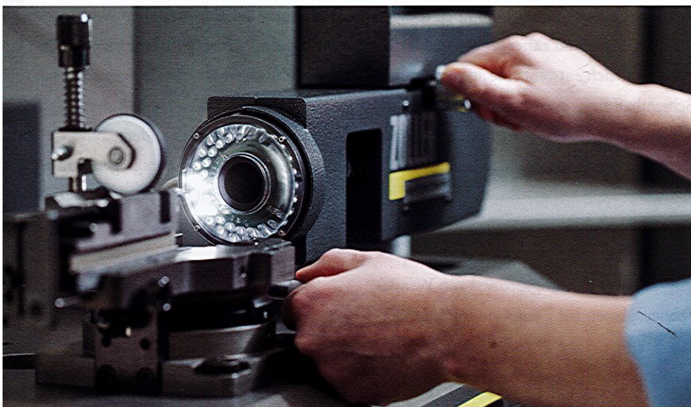
Das manuelle Messgerät eignet sich zur Vermessung der Werkzeuge direkt neben der Schleifmaschine und zur Ermittlung der Werkzeugparameter nach jedem Arbeitsschritt.
