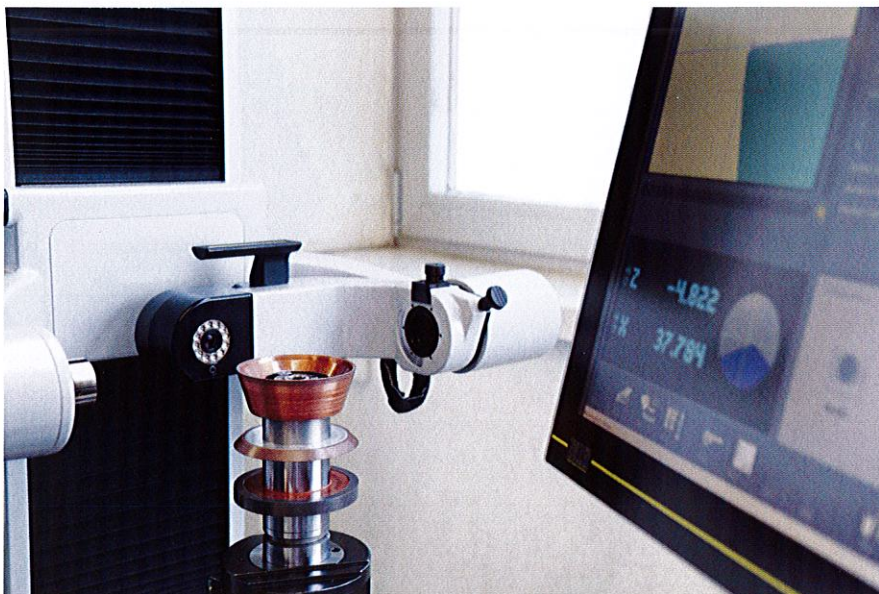
Bild 4: Berührungslose Messung der Schleifscheiben im Durchlicht am Einstell- und Messgerät (Werkbilder: E. Zoller GmbH & Co. KG, Pleidelsheim)
