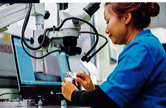
Jede RX-Schneide wird unter einem digitalen Inspektions-Mikroskop geprüft und bei Mängeln aussortiert.
