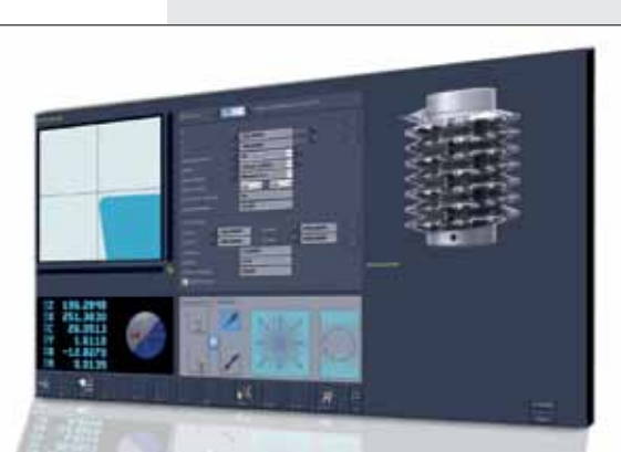
Bild 1: Die Neuerungen umfassen weltweit einmalige Funktionen wie das »cris« 3D-Messverfahren für genaues Messen von spiralisierten Werkzeugen
