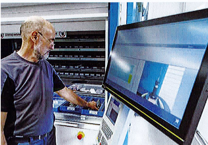
Dank der grafischen Lageroberfläche des Zoller-Toolmanagements holt sich ein SIM-Mitarbeiter das gewünschte Werkzeug zielsicher aus dem Werkzeuglager des Hänel-Lifts. Bild: Zoller
