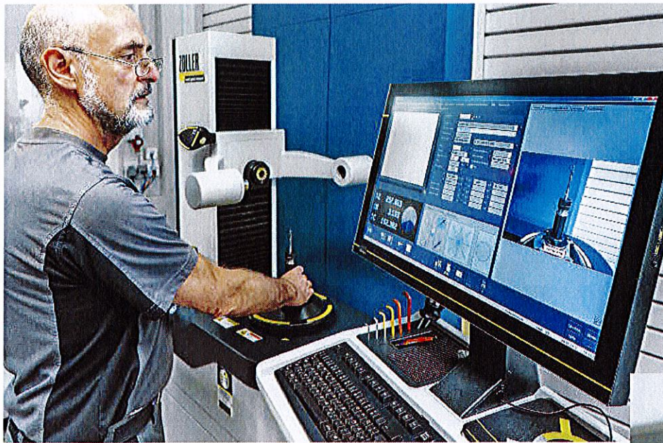
Durch das von Solidcam übermittelte Einrichteblatt erfährt der Zerspaner, welches Werkzeug zur Fertigung benötigt wird ... Bild: Zoller
