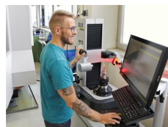
ZOLLER-Universalmeßmaschine »genius« ProProTec zur Komplettkontrolle der Werkzeuge
