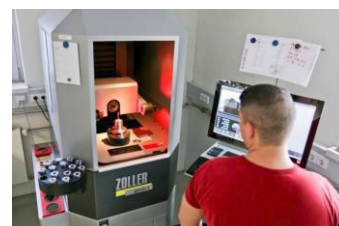
ZOLLER-Universalmeßmaschine »genius« ProProTec zur Komplettkontrolle der Werkzeuge
