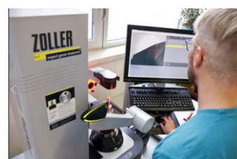
Schnelle und einfache Werkzeuginspektion einzelner Parameter am »smile« mit »pilot 3.0«
