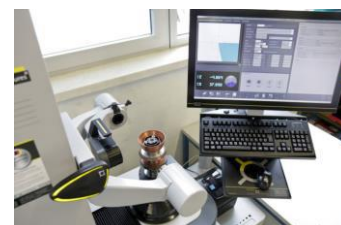
Neben Werkzeugen kann »smile« mit »pilot 3.0« auch Schleifscheibenpakete vermessen
