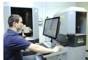
Uwe Schenn, oficial de producción, midiendo herramientas en la máquina de medición universal »genius«
