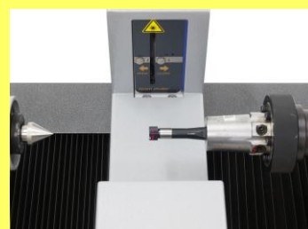
Carré conducteur universel avec mesure au laser haut de gamme
