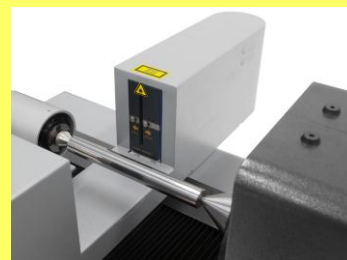
Mesure ultra-précise de la concentricité d'arbres fixés entre des pointes.
