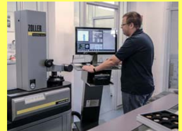
»smarTcheck« ツール測定器により、寸法の精度を大幅に向上させます。
