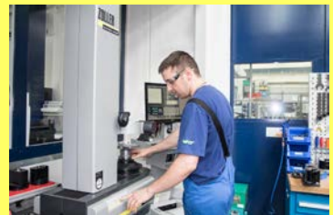
スイスのハーグにあるVAT社で非常に複雑な工具を測定、検査する>>venturion 450/8<<
