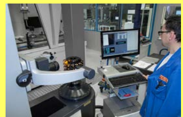
SANDVIK Tooling Supply Schmalkalden内、製品検査室にある ZOLLER社製 »hobCheck 800«
