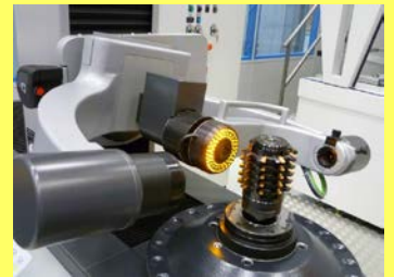
ZOLLER社による、ソフト及び画像処理技術を用い、CNC-4軸制御、非接触式全自動測定が可能に
