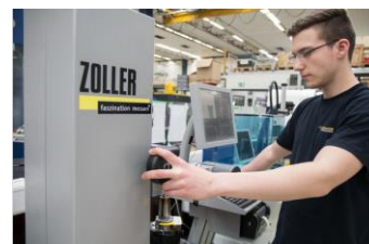
Устройство с ЧПУ для предварительной размерной настройки и измерений режущего инструмента Venturion 450, произведенное компанией ZOLLER
