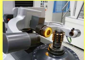
4 оси ЧПУ, ПО и обработка изображений ZOLLERобеспечивают полностью автоматический процесс измерения.
