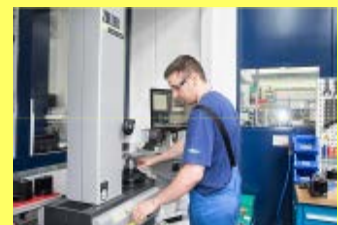
На заводе Haag в Швейцарии: оператор машины "Venturion 450/8" измеряет и проверяет сложный режущий инструмент.
