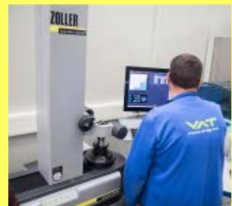
Обработка изображений на машине "venturion" с помощью "pilot3.0" всегда обеспечивает надежные результаты - независимо от оператора.
